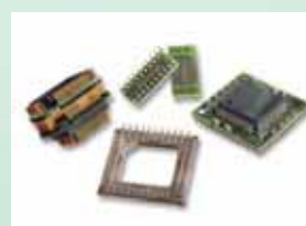
Adaptadores PLCC, SOIC, emulador test Sunhayato™ CI
