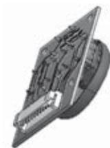
El conector en el módulo Navimec<sup>™</sup> es JST SMT S10B-PH-SM3-TB o similar. Recomendamos utilizar Zócalo Cable: JST PHR-10 o similar. Contacto: JST SPH-002T-PO.5S o similar.
